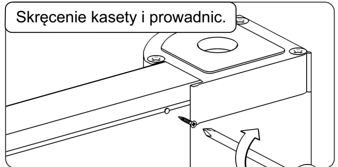
Złożenie prowadnic i listwy hakowej z wykorzystaniem łącznika prowadnic zaślepek dolnych.
